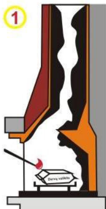
1 Детали отопительного прибора и дымоход покрываются смолистыми отложениями.
